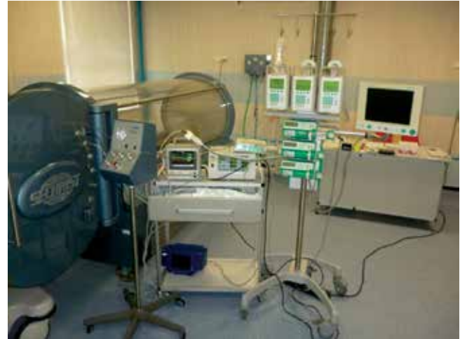
Рис. 1. Реанимационная барокамера Sechrist-3200 (США) с респиратором Sechrist Model 500A Hyperbaric Ventilator (США), монитором ЖВФ и модулем для инфузии
